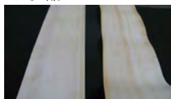
左側 新製品 右側 従来品（収縮で波打ち）
