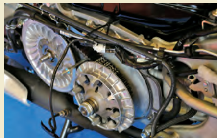
大型バイク等にも採用されている、音が静かで変速がスムーズな“自動二輪車用変速ベルト”
