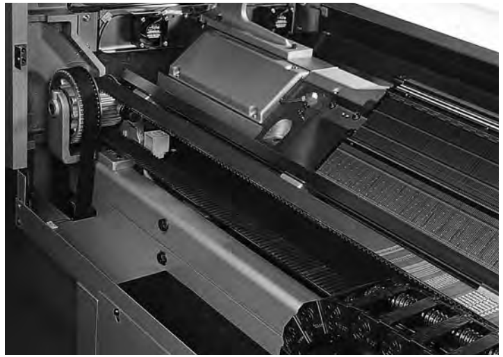
大型ニットマシン(スーパートルクGタイミングベルト)
