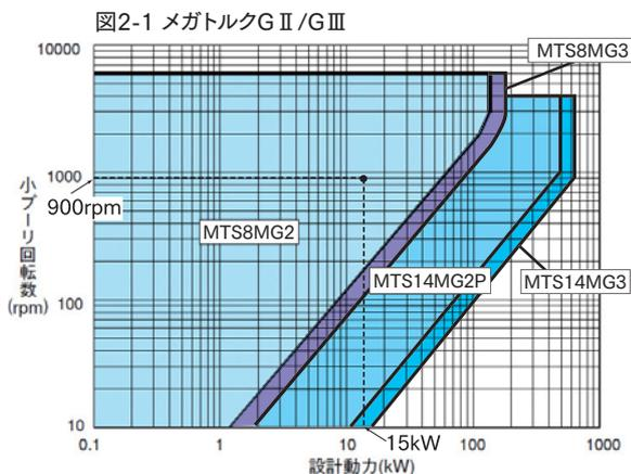
P38の図2-1簡易ベルト形選定表よりベルト形を求めます。
