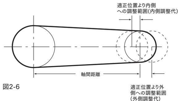
ベルトを正しくプーリに装着させるために必ず軸間距離調整代をつけてください。
